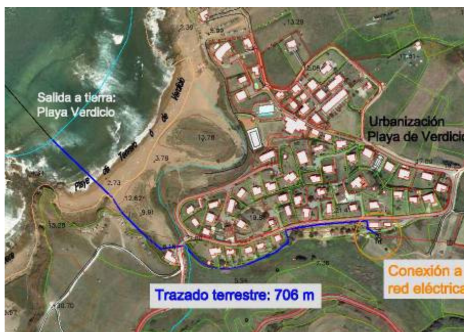
Figura 22. Detalle del trazado terrestre de la línea de evacuación.
